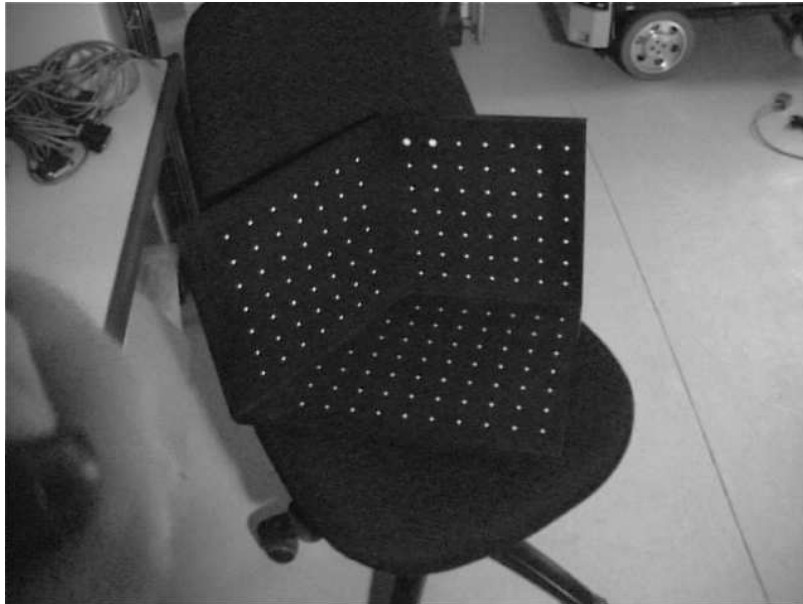
FIG. 1.3 – La mire de calibrage utilisée dans le projet MOVI.
