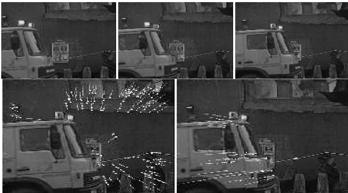
FIG. 5.6 – Trois images d’une séquence : le camion se dirige vers la droite, la caméra recule devant la scène. Les deux images en bas montrent les deux mouvements apparents qui ont été segmentés : fond et camion. Images prises de : P. Torr, « Motion Segmentation and Outlier Detection », Thèse de Doctorat, Université d’Oxford, 1995.
